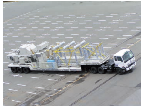
Left : Trailer A, HV Switchgear
